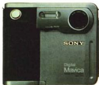
Con la nuova Digital Mavica Sony introduce la prima fotocamera magnetica al mondo che utilizza un comune floppy disk come supporto di memorizzazione. È disponibile sia in versione con fuoco fisso che con zoom 10x.
